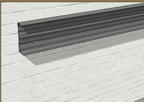
Bevestiging muurprofiel bij wandmontage
